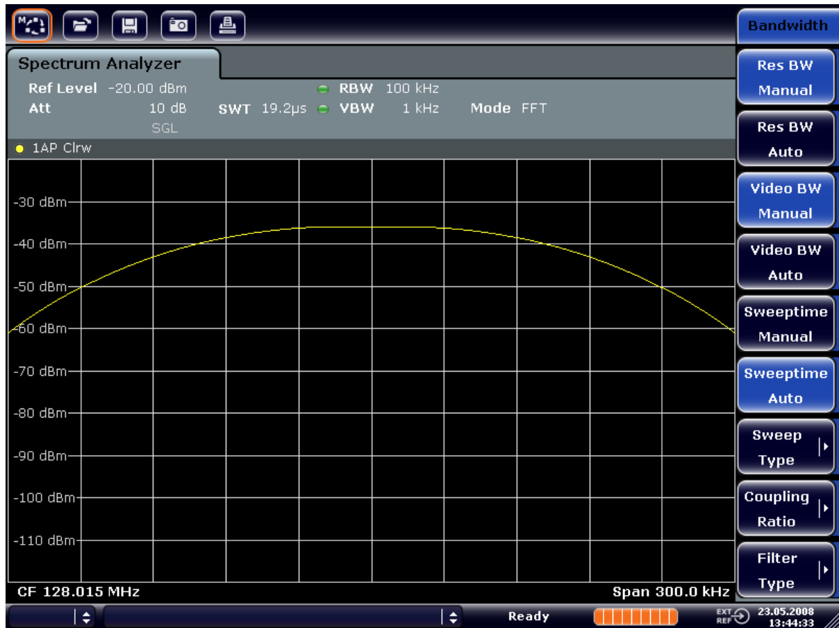
그림 6-5: 해상도 대역폭이 주파수 추출 간격보다 더 큰 두 개의 균등 RF 정현 신호 측정
