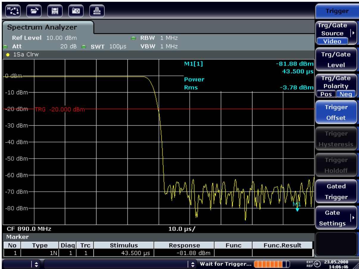
그림 6-10: 높은 시간 해상도가 있는 GSM 버스트의 하강 Edge
